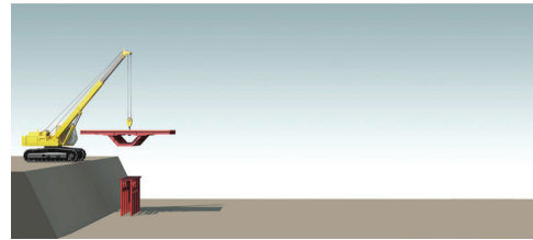
1차 모듈화 된 지점주형 및 Y 벤트 설치
